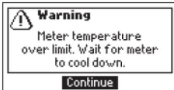
기기가 과열되어 있거나, 정확한 측정을 하기 위한 온도에 비해서 너무 춥다. 측정 전, 기기 온도가 0°C~50°C 사이가 되도록 한다.
