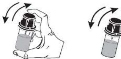
시약의 새는 것을 방지하고 보다 정확한 측정을 위해서 큐벳을 HDPE 플라스틱 스토퍼로 일차적으로 막고, 검은색 뚜껑을 닫는다. 큐벳을 기기 홀더에 넣을 때, 항상 깨끗하고 마른 상태이고 지문이 없어야 한다. HI731318 또는 보풀이 없는 천으로 넣기 전에 전체적으로 닦는다. 큐벳을 흔들 때 샘플에 생긴 거품들이 높은 수치의 결과를 낼 수 있다. 정확한 측정 결과를 위해서 큐벳을 흔들거나 가볍게 두드려서 거품을 제거한다.
