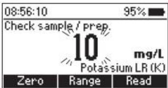
측정값이 측정 가능한 범위를 벗어났다. 샘플이 부유물을 포함하고 있는지 확인한다. 샘플 준비와 측정 과정을 다시 확인한다.
